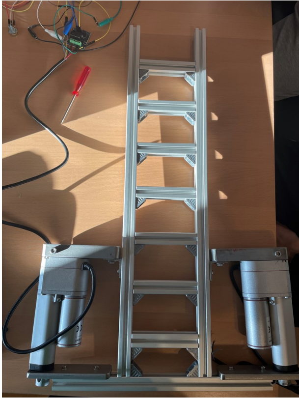
Abb. 1: Modell-Leiter zur Bestimmung der Standfestigkeit [1]
