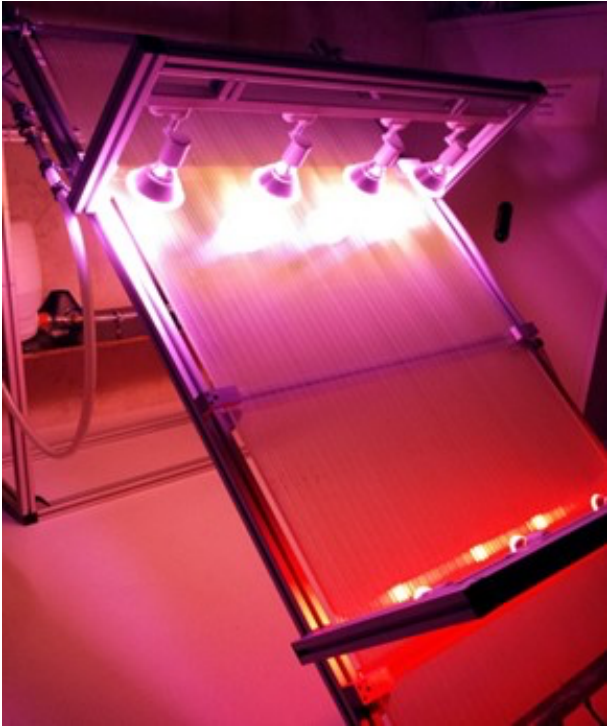
Abb. 3: Photoalgenreaktor mit Wachstumslampen [4,5]
