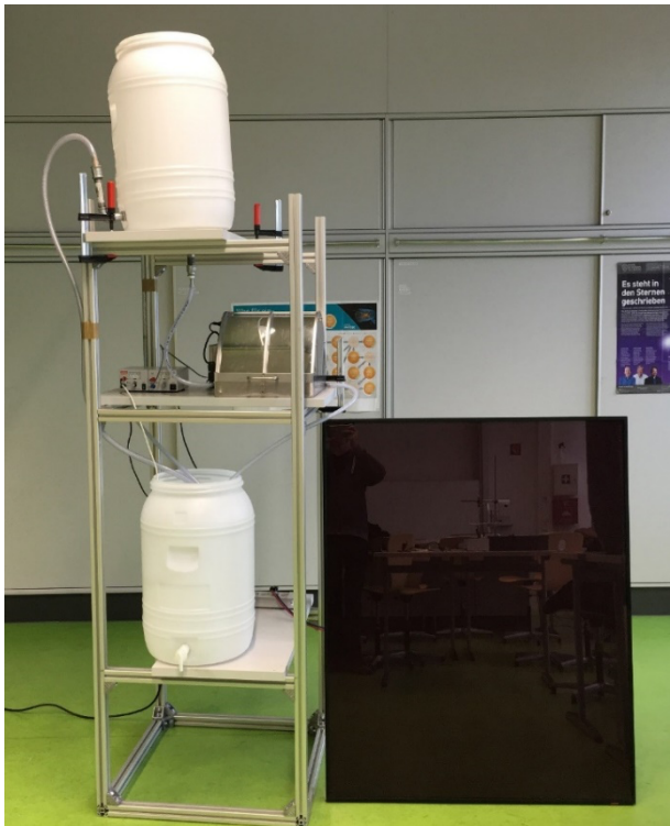
Abb. 2: Dekontaminator zur Erzeugung von Trinkwasser aus gelagertem Regenwasser [2,3]
