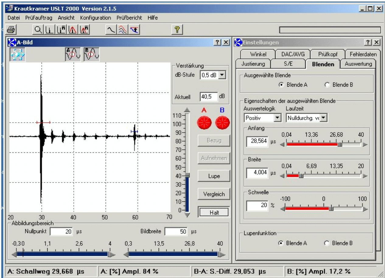
Abb. 2: Originalmessdaten des Ultraschallgeräts für Eigelb bei einer Temperatur  $T = 66\text{ °C}$ .
