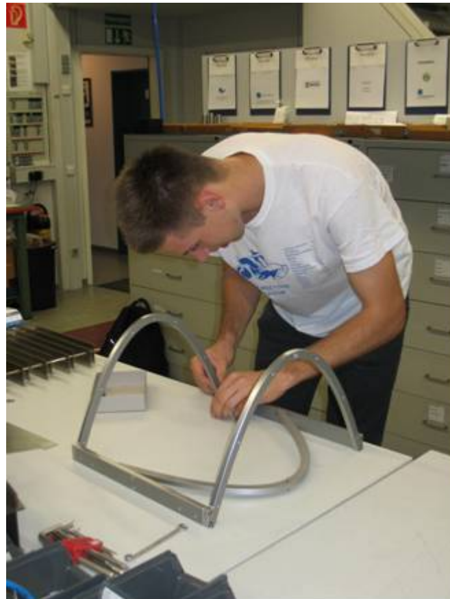
Abb. 1 K. Müller bei der Montage des Gehäuses der Apparatur zur Dekontamination von Regenwasser.
