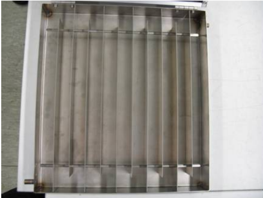
Abb. 3a: Gitter eingesetzt in den Boden der Dekontaminationsanlage.
