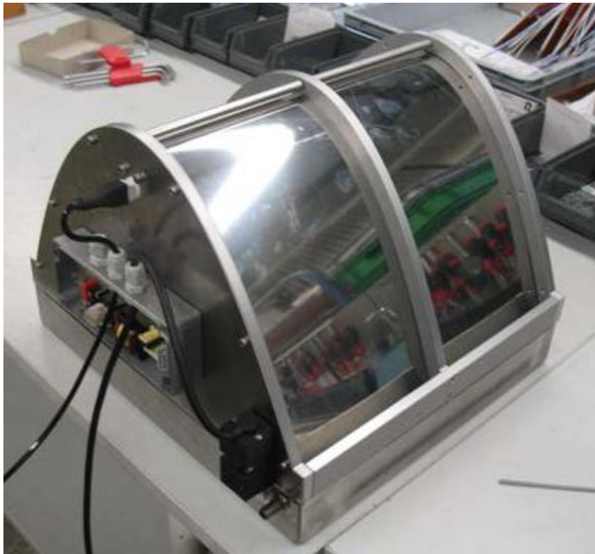
Abb. 4: Dekontaminationsanlage. Links an der Seitenfläche ist die Elektronik der UV-Lampe montiert.
