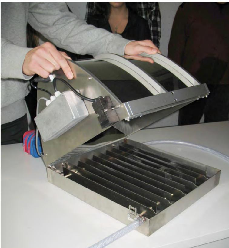
Dekontaminationsanlage zur Trinkwassergewinnung
