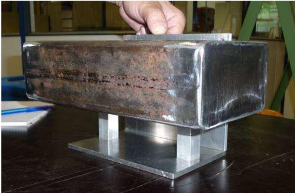
Abb. 3.3: Gehäuse (noch nicht lackiert) des Seifenspenders während der mechanischen Fertigung. Nicht montiert sind die Düse, ein USB-Anschluss für die Programmierung und die Bewegungssensoren.
